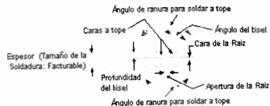
Figura 1— Soldadura a Tope de Doble V
