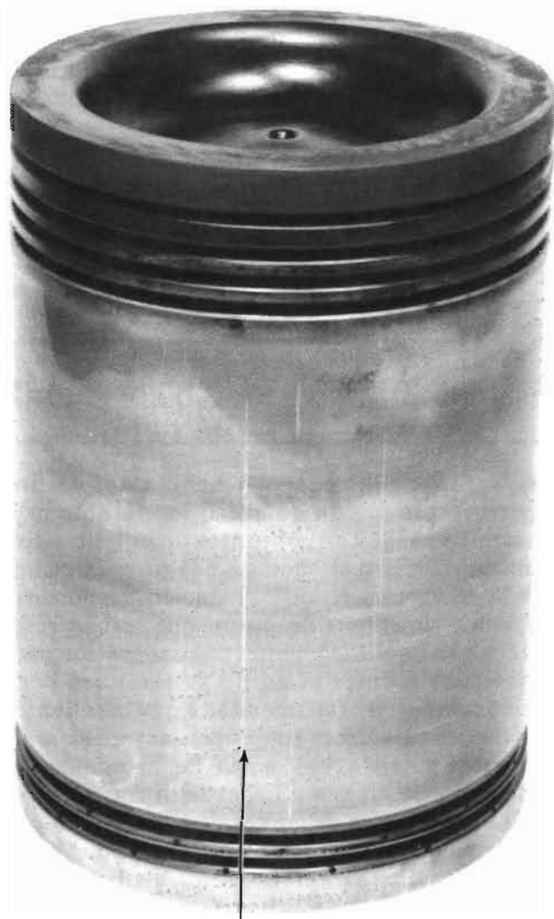
Las rayaduras superficiales provocadas por la mugre no son causa de remoción del pistón
