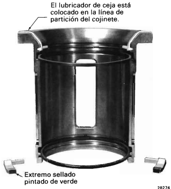
Fig.2 - Cojinete de suspensión de sello gemelo con felpas aseguradas en posición
