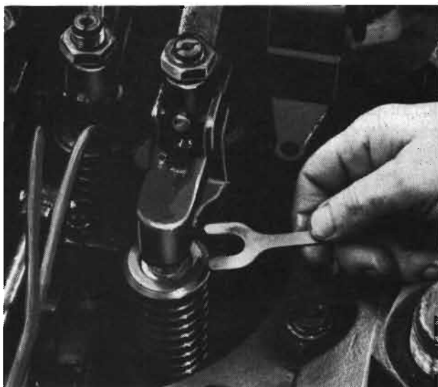
Fig.6 - Comprobación del claro existente entre el ajustador hidráulico y la válvula
