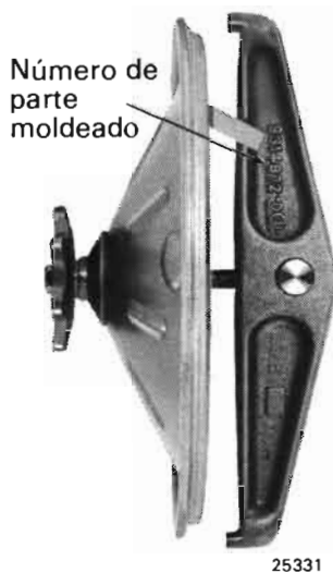
Fig.6 – Identificación de la barra interior típica de alta resistencia
