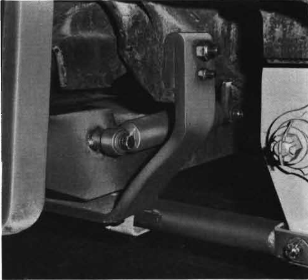
Fig.3 - Instalación de amortiguador horizontal en locomotora Modelo F40PH
