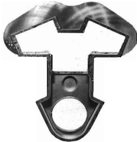
Fig.2 - Empaque 8081380 aplicado a la caja de impulsión de auxiliares
