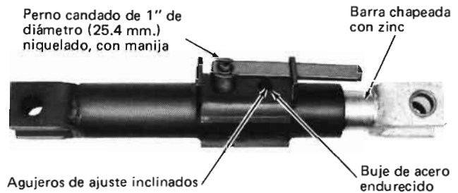
Fig. 3 - Ajustador de juego tipo perno para frenos de zapata sencilla
