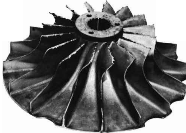
Fig. 4 – Falla típica de rotor del sistema de aire provocado por materias extrañas.
