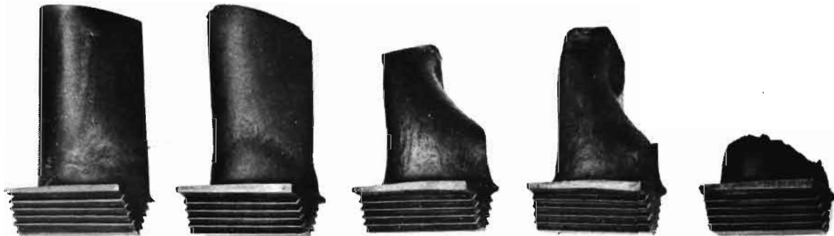
Fig. 2 - Falla progresiva de una aspa de turbina por excesivo sobrecalentamiento.
