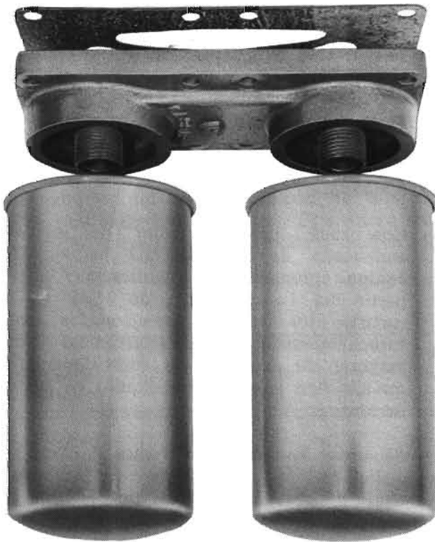
Fig. 4 - Cartuchos, adaptador y empaque para motores 567B, 567BC y 567C de temprana producción
