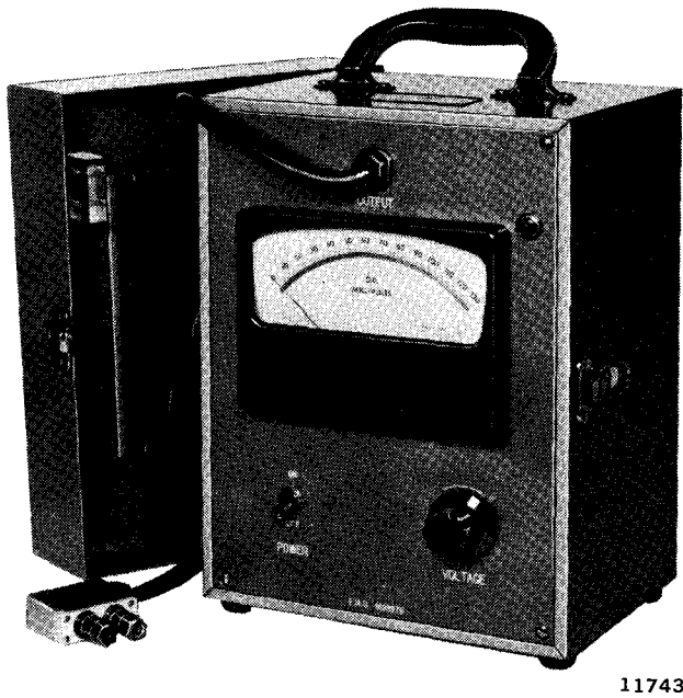
Fig. 2 – Meter Tester Assembly
