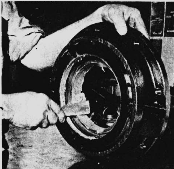
Fig. - 2 Aplicación de grasa en las ranuras del laberinto
