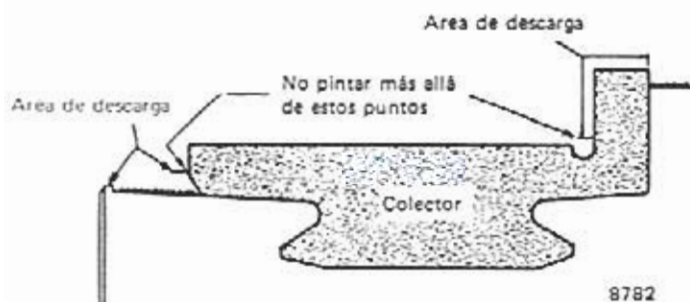
Fig. 4 - Cuidado del área de descarga del colector
