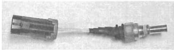
Figura 4.13 Sensor de temperatura de combustible.
