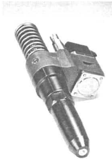
Figura 1.2 Inyectores electrónicos (EUI).
